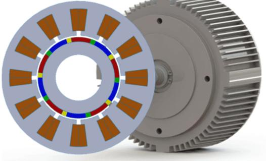
Figure 1- PM Halbach array motor
